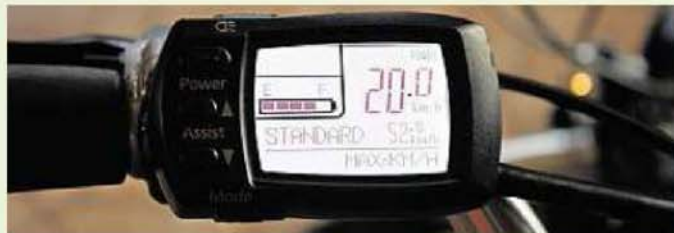
Die elektronische Anzeige der E-Bikes informiert auch über den Akku-Ladezustand.
